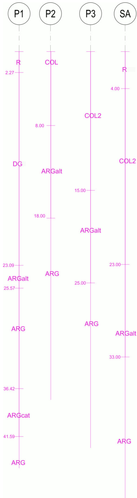
Figura 3.5 – Stratigrafia di riferimento sulle verticali di pile e spalle ramo di svincolo
